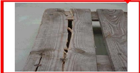
Трещина и доска не прибита гвоздями
