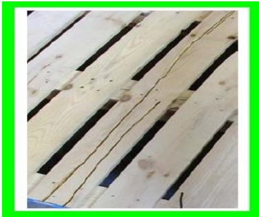
Трещины: 1 по всей длине, но доска прибиты с двух сторон
