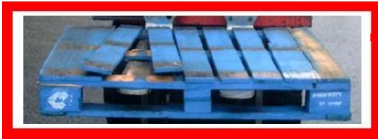
Отсутствие элементов и сломанные доски по всей ширине
